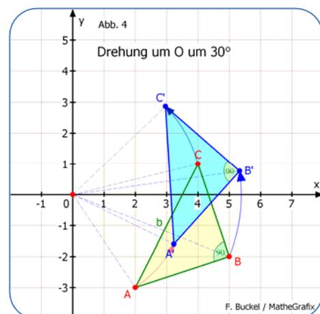
**Beispiel 8:**  $\vec{x}' = x \begin{pmatrix} \frac{1}{2} \\ \frac{1}{2}\sqrt{3} \end{pmatrix} + y \begin{pmatrix} \frac{1}{2}\sqrt{3} \\ -\frac{1}{2} \end{pmatrix} + \begin{pmatrix} -\frac{3}{2}\sqrt{3} \\ \frac{9}{2} \end{pmatrix}$  bzw.  $\vec{x}' = \begin{pmatrix} \frac{1}{2} & \frac{1}{2}\sqrt{3} \\ \frac{1}{2}\sqrt{3} & -\frac{1}{2} \end{pmatrix} \vec{x} + \begin{pmatrix} -\frac{3}{2}\sqrt{3} \\ \frac{9}{2} \end{pmatrix}$
