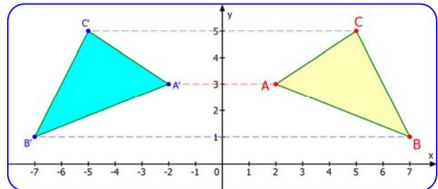
Beispiel: **B(7|1)** soll an der y-Achse gespiegelt werden. Sein Ortsvektor ist  $\vec{b} = \begin{pmatrix} 7 \\ 1 \end{pmatrix}$ .
