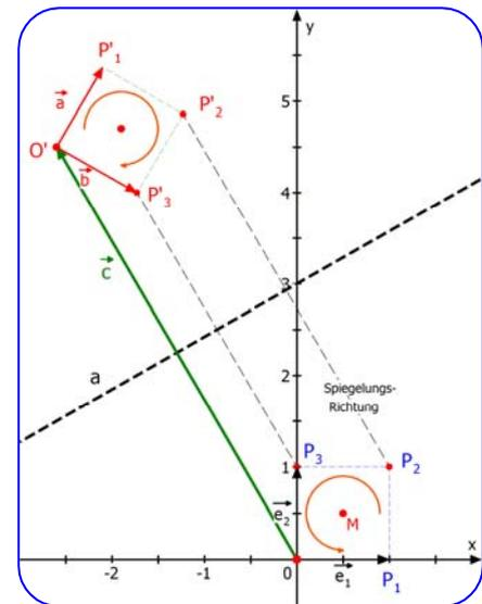
**Beispiel 9:**  $\vec{x}' = \begin{pmatrix} \frac{1}{2} & \frac{1}{2}\sqrt{3} \\ \frac{1}{2}\sqrt{3} & -\frac{1}{2} \end{pmatrix} \vec{x}$  Achsenspiegelung
