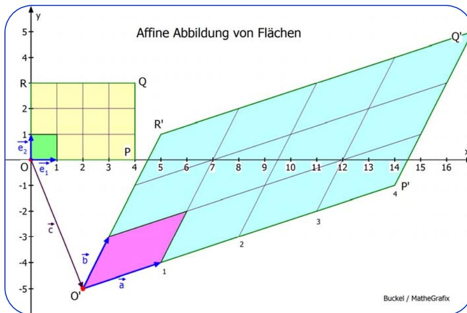
Dabei ist  $\vec{a}$  der Bildvektor von  $\vec{e}_1$  und  $\vec{b}$  der Bildvektor von  $\vec{e}_2$ . Man erkennt, dass dabei das von  $\vec{e}_1$  und  $\vec{e}_2$  aufgespannte Einheitsquadrat (das quasi die Maßeinheit der Flächeninhalte darstellt) in das Parallelogramm übergeht, das durch  $\vec{a}$  und  $\vec{b}$  aufgespannt wird.
